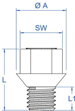
Metrischer Stopfen mit Konus und Sechskant, zum Abdecken von Innengewinde, wobei die 90° Senkung mit abgedeckt wird.
