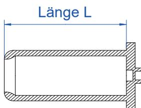
Durch die eingegossene Ventilfunktion, sowie die Dichtlippen im Inneren der Kappe, kann keine Flüssigkeit in das Kappeninnere mehr eindringen. Nach dem aktivieren des Entlüftungsventil, kann entstandener Druck aus Hohlräumen oder Sacklöchern problemlos entweichen.
