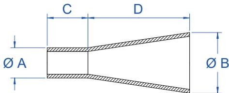
Zum Abdecken von Bohrungen, durch die konische Form kann die Kappe für verschiedene Durchmesser verwendet werden.
