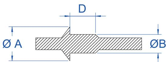
Der Durchziehstopfen mit Rand ist ideal zur Innenabdeckung von Gewinden und Löchern mit Randabdeckung geeignet.
