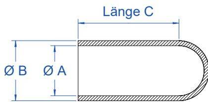
Einseitig geschlossen, ideal zum Abdecken von Gewindestiften, Bolzen und Passbohrungen.
