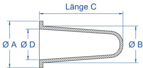
Einseitig geschlossen mit Kragen, ideal zum Abdecken von Gewindestiften, Bolzen und Passbohrungen mit Kontaktfläche.
