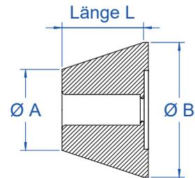
Zum Verschließen von Rohren und langen Durchgangsbohrungen. Zur Verwendung mit GH-M8 Gewindehülse.
