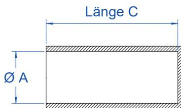
Einseitig geschlossen, ideal zum Abdecken von Gewindestiften, Bolzen und Passbohrungen.
