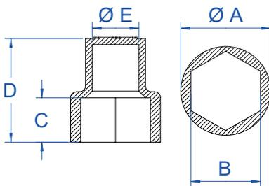
Einseitig geschlossen, zum Abdecken von Sechskantschrauben, -muttern und -anschweißmuttern.
