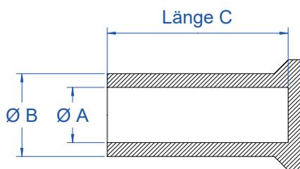
Einseitig geschlossen, ideal zum Abdecken von Gewindestiften, Bolzen und Passbohrungen. Einfaches Handling beim Aufstecken und Abziehen durch den Griff an der Bodenseite der Kappe.
