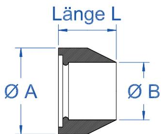
Hitzebeständige Stopfen, die in Verbindung mit den rechts aufgeführten Gewindebolzen eine kontaktgebende Abdichtung für Gewinde herstellen.
