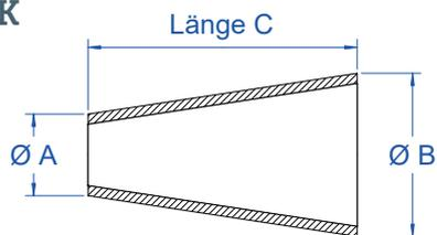
Zum Abdecken von Bohrungen, durch die konische Form kann die Kappe für verschiedene Durchmesser verwendet werden.
