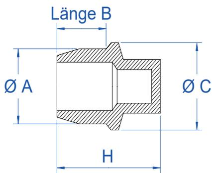
Kurzer, metrischer Stopfen mit Schräge und Griff wodurch das Aufsetzen und Abziehen erleichtert wird. Durch seine Form (Rand) ist der Stopfen ideal für Gewinde (erster Gewindegang bleibt lackfrei).
