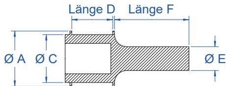
Der Durchziehstopfen mit Doppellippe ist ideal zur Innenabdeckung von Gewinden und Löchern mit beidseitiger Randabdeckung.
