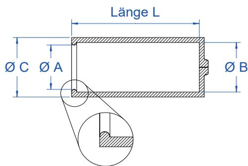
Die integrierte Druckentlastung sorgt dafür, dass sich die Kappe auch bei Luft einschüssen nicht hochschiebt. Ideal zum Abdecken von Gewindestiften, Bolzen und Passbohrungen. Durch die Lippe wird das Aufsetzen und Abziehen erleichtert.
