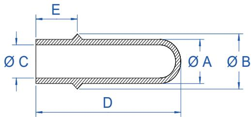
Kappe mit Kragen, ideal zum Abdecken von Gewindestiften, Bolzen und Passbohrungen mit Senkloch.
