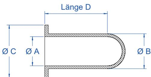
Einseitig geschlossen mit Kragen, ideal zum Abdecken von Gewindestiften, Bolzen und Passbohrungen mit Kontaktfläche.
