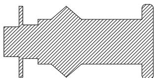
Durch einfaches Drücken wird der Stopfen in die Gewindebuchse / Mutter eingebracht und deckt diese von zwei Seiten ab.
