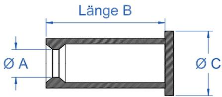
Ideal für große Durchmesser und lange, glatte Achsen. Durch die Lippe wird das Aufsetzen und Abziehen erleichtert.
