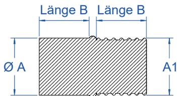
Durch leichtes Eindrehen erhält dieser Stopfen, der mit Rillen versehen ist, einen perfekten Halt.
