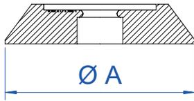
Zum Maskieren von Flächen um Bohrungen wie Erdungsflächen und ähnliches. Zur Verwendung mit GH-M8 Gewindehülse.
