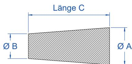
Zum Verschließen von Bohrungen und Gewindeeinsätzen.
