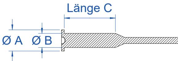
Der Ziehstopfen ist so entworfen, dass er Gewindebuchsen durch einen Zug sauber verschließt.
