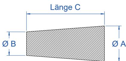
Zum Verschließen von Bohrungen und Gewindeeinsätzen.
