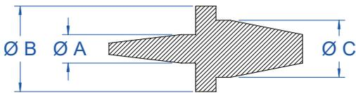
Zum Verschließen von Bohrungen und Gewindeeinsätzen. Der Stopfen kann für zwei verschiedene Maße eingesetzt werden und lässt den Rand lackfrei.
