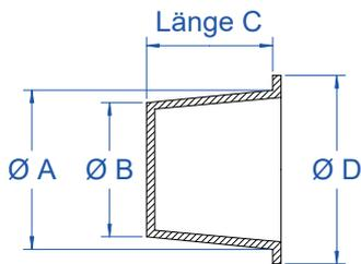
Kappe speziell für die Fahrradindustrie entworfen, verschließt die meisten Löcher an Rahmen und Radlagern.
