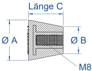
Zum Verschließen von Rohren und langen Durchgangsbohrungen. Durch die Verbindung zweier Stopfen mit einer Gewindestange (s. S.172) wird der sogenannte „Blowout“ zuverlässig verhindert.
