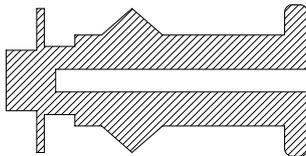
Durch einfaches drücken wird der Stopfen in die Gewindebuchse / Mutter eingebracht und deckt diese von zwei Seiten ab. Mithilfe des Loches kann der Stopfen noch einfacher eingedrückt werden, Einsteckhilfe beigelegt.
