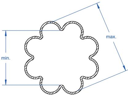
Durch die Sternform wird das Aufsetzen und Abziehen erleichtert. Farbcodiert. Auf Wunsch können auch Schlauchstücke auf Länge geschnitten werden.
