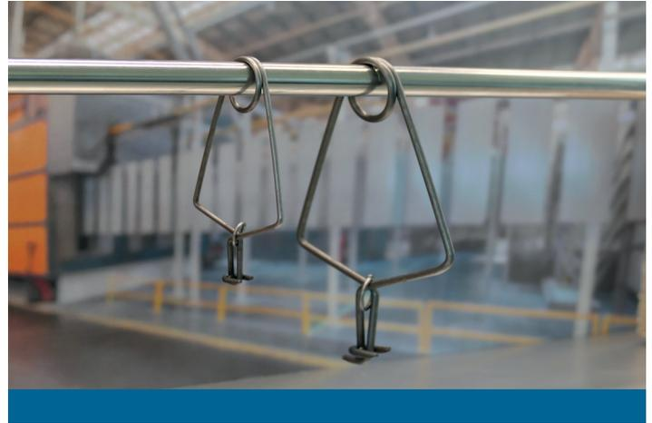
Rohrhaken sind ideal zum Aufhängen von Rohren mit einem Durchmesser bis 60,0 mm abhängig von Gewicht und Vibrationen an der Kettenbahn.
