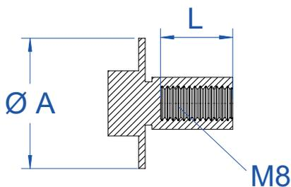
Für die auf der linken Seite aufgeführten Schraubensystemstopfen und -scheiben ist selbstverständlich auch eine Auswahl an Gewindehülsen vorhanden. Für beinahe jeden Zweck einsetzbar durch zahlreiche Kombinationsmöglichkeiten in Kombination mit einer Gewindestange (s. Seite 172)
