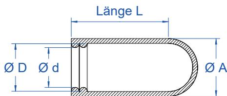
Einseitig geschlossen, ideal zum Abdecken von Gewindestiften und Bolzen. Diese Kappen besitzen eine Rille zur sicheren Abdichtung gegen eindringende Flüssigkeiten und erleichtert das Aufsetzen und Abziehen.
