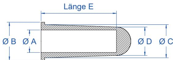
Einseitig geschlossen mit Kragen, ideal zum Abdecken von Gewindestiften, Bolzen und Passbohrungen mit Kontaktfläche.
