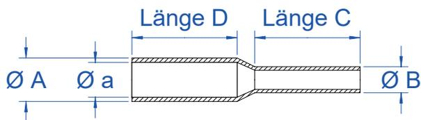
Keine Medien-Verschleppung in Bädern aufgrund der durchgehenden Bohrung dieses Durchziehstopfens. Hervorragend geeignet in KTL und Galvanik. Kostengünstige Alternative zu unseren massiven Durchziehstopfen (cpp).
