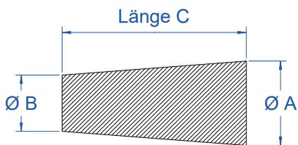
Durch leichtes Eindrehen erhält dieser konische Durchziehstopfen aus flexiblem Material (40° Shore A) einen perfekten Halt und kann für mehrere Gewindegrößen bzw. Bohrungsdurchmesser verwendet werden.
