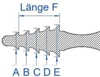
Durch leichtes Eindrehen erhält dieser Lamellenstopfen einen perfekten Halt und kann für mehrere Gewindegrößen bzw. Bohrungen verwendet werden, zudem auch geeignet für Sacklöcher und Gewindelöcher.
