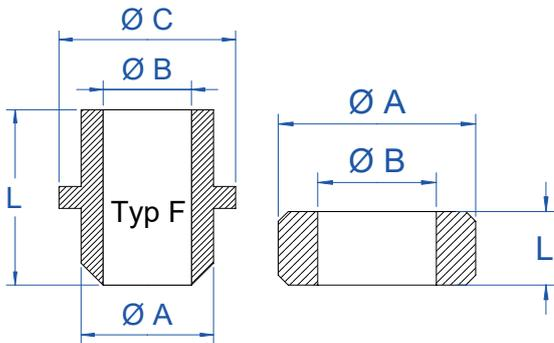
Zum Abdecken von Bohrungen, Achsen und Gewindeeinsätze.
