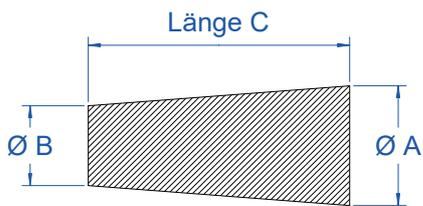
Zum Verschließen von Bohrungen und Gewindeeinsätzen.
