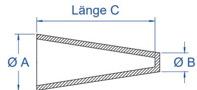
Einseitig geschlossen zum Abdecken von Gewindestifte, -bolzen und Passbohrungen.
