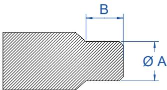
Metrischer Stopfen mit Schräge und Griff wodurch das Aufsetzen und Abziehen erleichtert wird. Durch seine Form (schräger Absatz) ist der Stopfen ideal für Gewinde (erster Gewindegang bleibt lackfrei).
