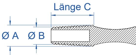
Zum Verschließen von Bohrungen und Gewindeeinsätzen. Das Material ist sehr flexibel und passt sich daher gut den Gewindegängen an.
