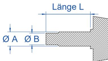
Selbstschneidende Stopfen zum Verschließen von Gewindelöchern. Ist durch seine Form einfach einzudrehen ohne das Flüssigkeit eintreten kann.
