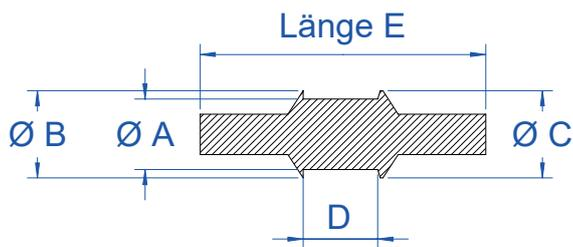
Zum Verschließen von metrischen Durchgangsbohrungen.
