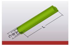
Die integrierte Druckentlastung sorgt dafür, dass sich die Kappe auch bei Lufteinschlüssen nicht hochschiebt. Ideal zum Abdecken von Gewindestiften, Bolzen und Passbohrungen. Durch die Lippe wird das Aufsetzen und Abziehen erleichtert.
