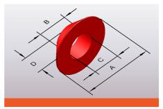
Fasenabdeckung für Bohrungen und Gewindegänge mit Senkung. Wird in Verbindung mit den entsprechenden Durchziehstopfen verwendet. Die Abdeckung kann ebenfalls entgegengesetzt als Flächenabdeckung um Löcher genutzt werden
